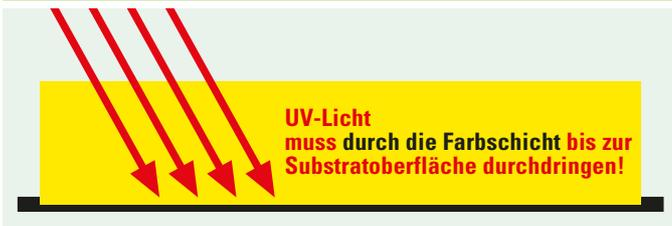
Um UV-härtende Tampondruckfarben sicher verarbeiten zu können, ist eine ständige Kontrolle des UV Trockners unerlässlich. Bei Durchlauf Trocknern kann dies am besten mit einem UV-Integrator (siehe Abb.) überwacht werden.
