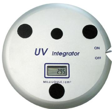
Leider liefern unterschiedliche UV Integratoren verschiedener Hersteller enorm unterschiedliche Ergebnisse. Die Unterschiede können bis  $\pm 50\%$  und mehr betragen. Daher ist es sinnvoll, den eigenen UV-Integrator abzugleichen oder diverse Trocknungsversuche mit unterschiedlichen Bandgeschwindigkeiten durchzuführen.
